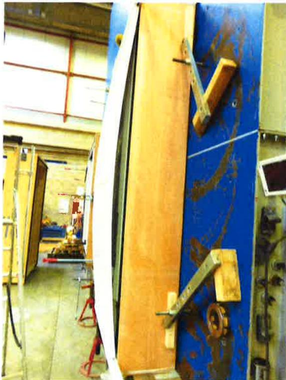
Essai de simulation de la pression à +600 Pa
